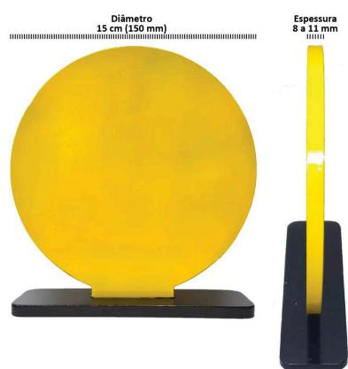
Os 4 (quatro) alvos metálicos redondos seguem o padrão do IPSC, em aço, com diâmetro de 15 cm, usando suporte fixo ao chão. Recomendamos que o clube tenha pelo menos mais 2 (dois) sobressalentes. Espessura padrão 3/8" (9,53 mm, tolerância de 8 a 11 mm).
